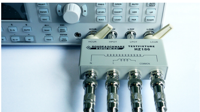
Abb. 8.6: Anschluss des Messadapters an der LCR-Messbrücke
